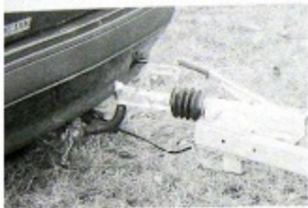
**Pour les modèles équipés d'une roue jockey, remonter celle-ci au maximum et serrer fortement.**
